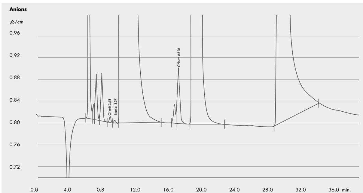
Abb. 1: Chromatogramm eines Mineralwassers, dem Bromat in der Höhe des schweizerischen Höchstwertes für Mineralwasser ( $3 \mu\text{g}/\text{l}$ ) zugesetzt wurde. Die Bestimmungsgrenze liegt mit der angewendeten Methode bei  $0.5 \mu\text{g}/\text{l}$
