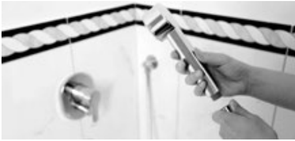
Abb. 2: Probenahme Duschwasser für die Untersuchung auf Legionellen nach TBDV. Probenmenge: 1l/Probe.
