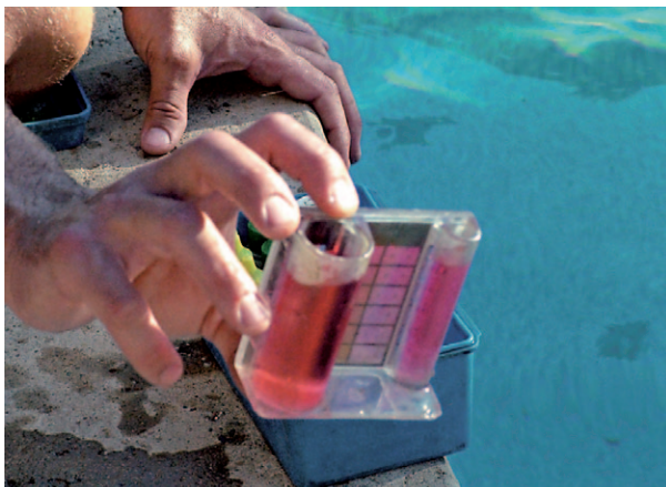
Regelmässige Kontrollen des Beckenwassers helfen die Badewasserqualität einzuhalten und bei Abweichungen frühzeitig Massnahmen zu treffen.
