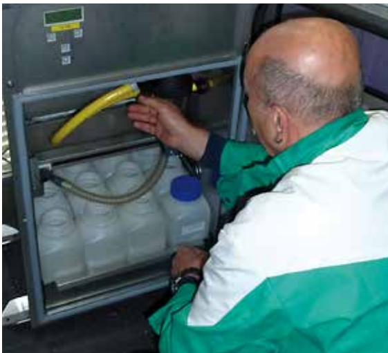
Installation des automatischen Probenehmers – das Abwasser kann vom Kanal zu diesem hinaufgepumpt werden.
